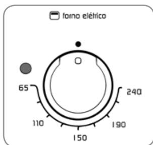
2. Gire o manípulo de controle do forno elétrico no sentido anti-horário até a temperatura mais adequada para o alimento que será preparado. Para indicar que o forno superior está sendo utilizado um led vermelho ficará aceso no painel;
