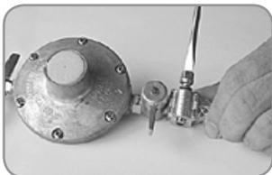
3. Coloque a outra braçadeira na extremidade oposta da mangueira. Em seguida, conecte a mangueira no regulador de pressão e, então, aperte a braçadeira com o auxílio de uma chave de fenda.
