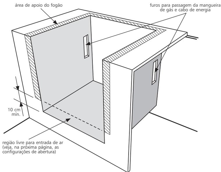
Os queimadores do forno necessitam de ar para seu correto funcionamento, portanto é necessário que o local de instalação proporcione aberturas na região inferior, verifique dentre as configurações de abertura de acordo com as figuras abaixo a melhor que se adapta ao seu móvel.
